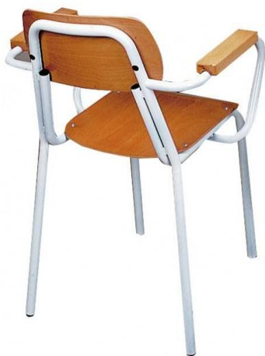
Poltroncina per cattedra della Linea Basic, realizzata in tubolare di acciaio di diametro mm 22 e spessore mm 1,5. Piedini in materiale antisdrucciolo e antirumore. Sedile e schienale in multistrato di faggio di spessore mm 7, perfettamente levigati e verniciati al naturale, sagomati anatomicamente, sedile con lembo curvo nella parte anteriore.
